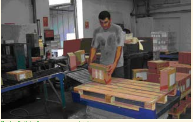
Resim 5. Palet üzerinde kaydırarak istif
