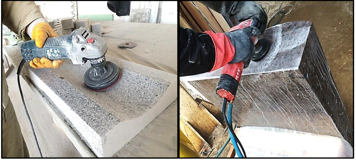
Resim 2.10. Spiral taşlama aleti ile el işçiliği uygulaması
