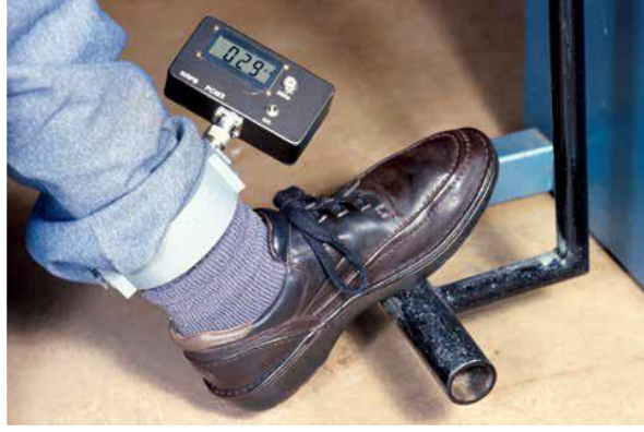
Şekil 2.6: 27 MHz dielektrik kaynak makinesi kullanırken uzuv akımını ölçmek için kullanılan bir akım pensi
