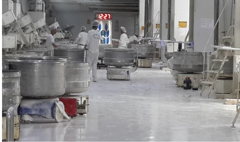
Resim 4.17. A işyerinde 600 kg ağırlığındaki hamur kazanlarının itilmesi-çekilmesi
