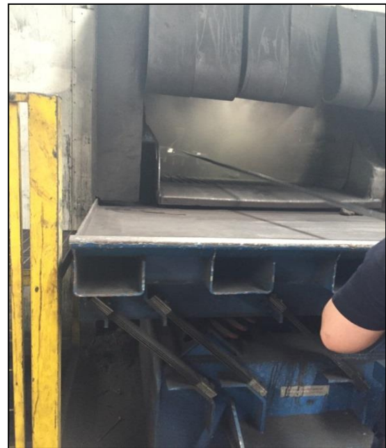
Resim A3 Solunabilir toz ve silis maruziyetinin azaltılması için kullanılan kapalı sarsak sistemi örnekleri
