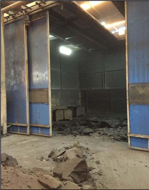
Resim A3 Solunabilir toz ve silis maruziyetinin azaltılması için kullanılan kapalı sarsak sistemi örnekleri
