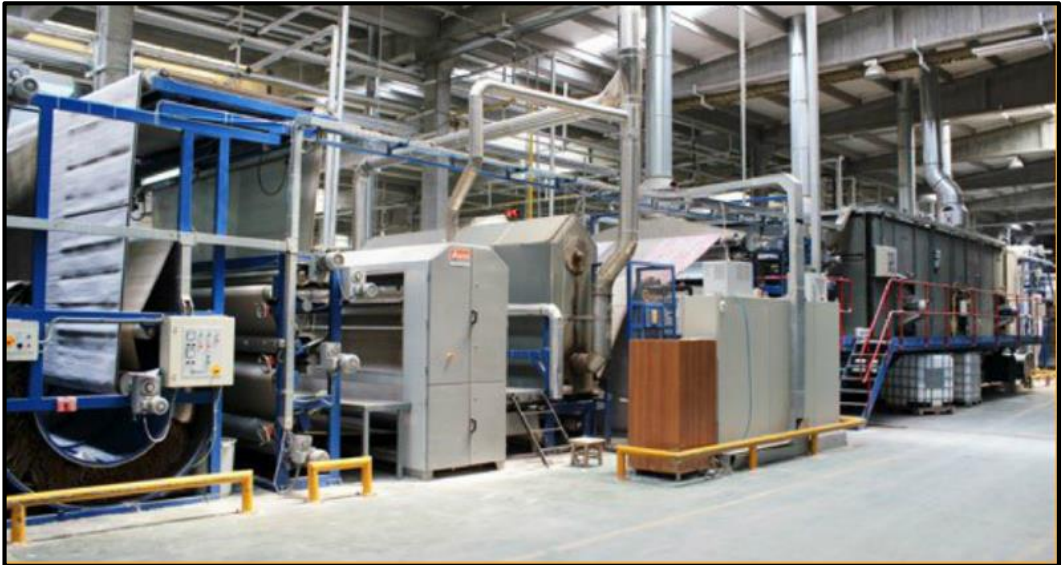
Şekil 2.19. Apre uygulama hattı [26]
