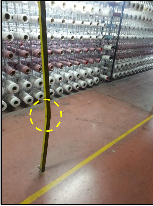
Resim 4.4. Forklift çarpması sonucu eğilen direk ve çarpmayı önleyen koruma
