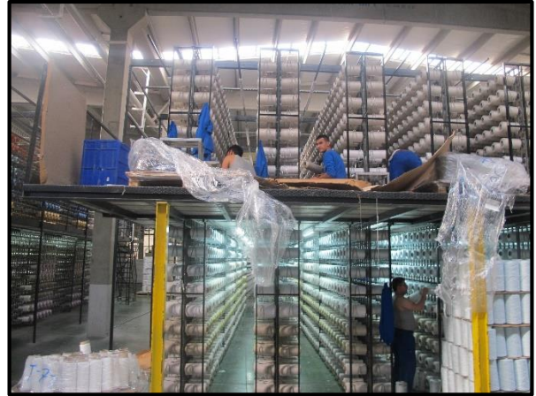
Resim 4.5. Korkuluk bulunmayan cağlık sistemleri
