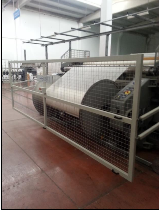
Resim 4.8. Koruması bulunan ve bulunmayan çözgü hazırlama makinesi
