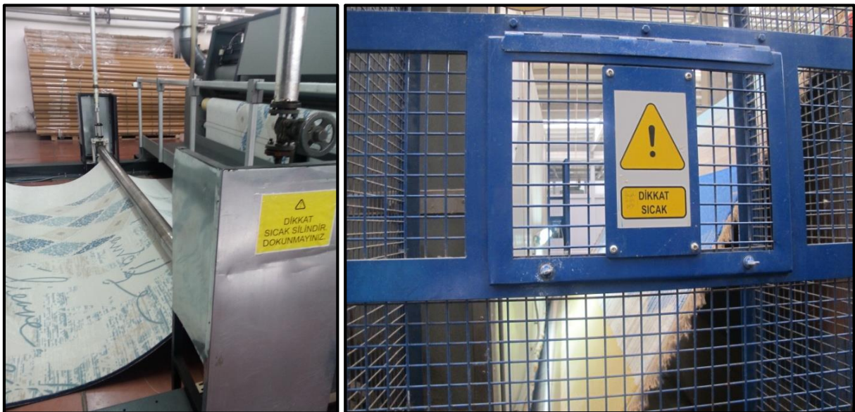
Resim 4.23. Korumasız ve korumalı apre silindirleri
