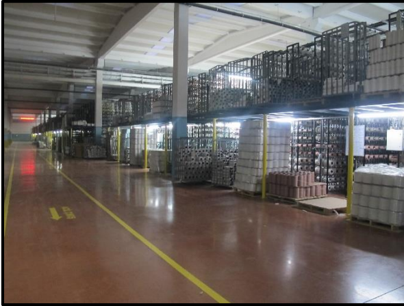
Resim 4.5. Korkuluk bulunmayan cağlık sistemleri
