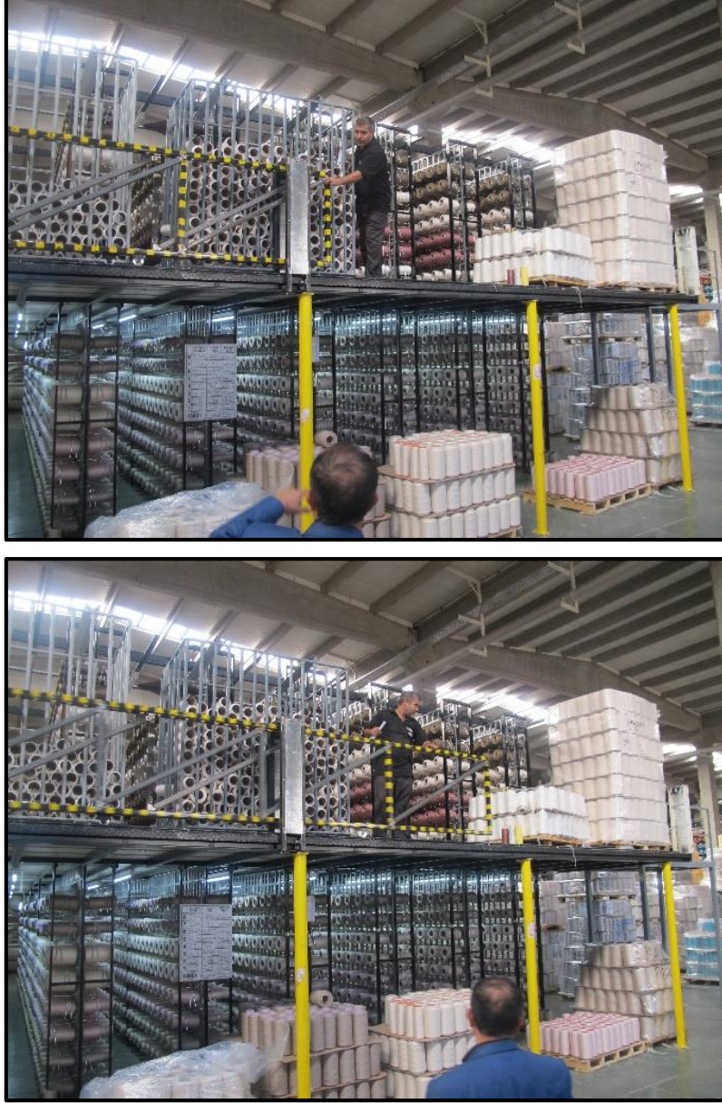
Resim 4.6. Korkuluk bulunan çağlık sistemleri
