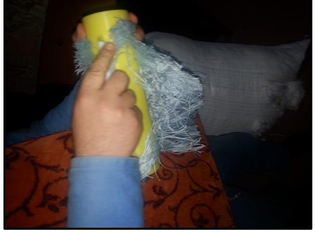
Resim 4.10. Iskarta ipliklerin bıçakla kesilmesi
