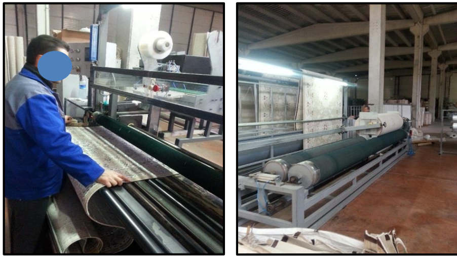
Resim 4.32. Halı büküm işlemi ve açıkta dönen silindirler
