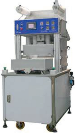
Resim22. Gaz Püskürtme Sistemleri
