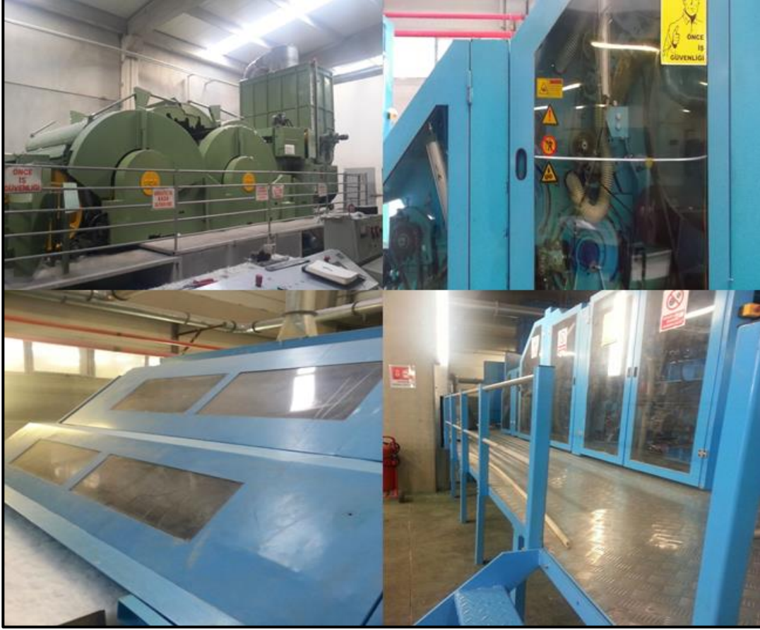
Resim 4.43. Tarak makinelerinde döner aksama uzuv kaptırma riskini ve uçuntuların ortama yayılmasını önlemeye yönelik muhafazalı tasarımlar
