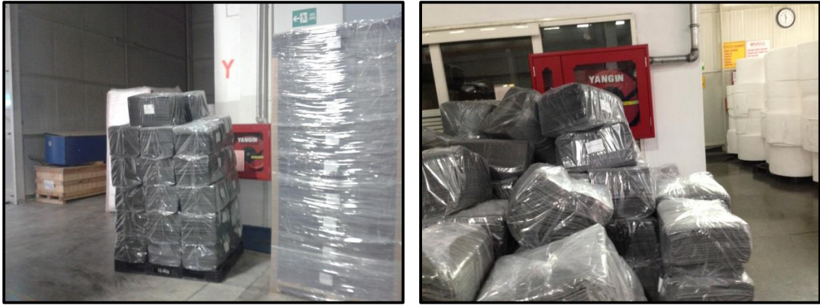
Resim 4.19. Yangın söndürme ekipmanlarının önlerine malzeme konulması
