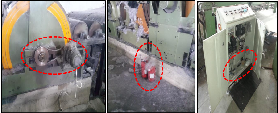
Resim 4.42. Makine bağlantı parçaları, tesisat ve ekipmanlar üzerinde uçuntu birikmesi
