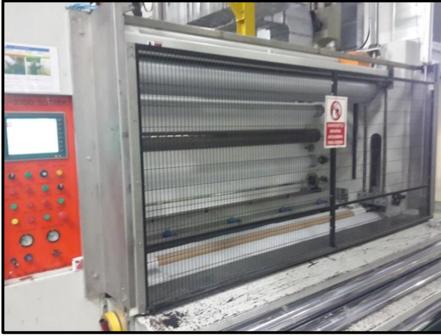
Resim 4.12. Kumaş sarma makinelerinde sarım ünitelerine uzuv kaptırma riskini önlemeye yönelik kafesli muhafaza ve makineyi durduran harekete duyarlı sensör sistemi uygulamaları
