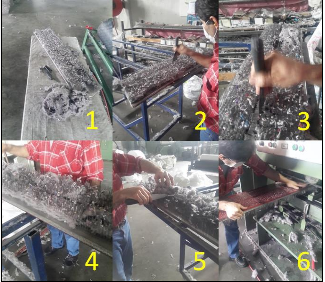
Resim 4.38. İğneli plaka temizleme işlemi aşamaları
