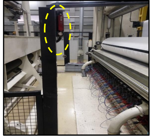
Resim 4.12. Kumaş sarma makinelerinde sarım ünitelerine uzuv kaptırma riskini önlemeye yönelik kafesli muhafaza ve makineyi durduran harekete duyarlı sensör sistemi uygulamaları
