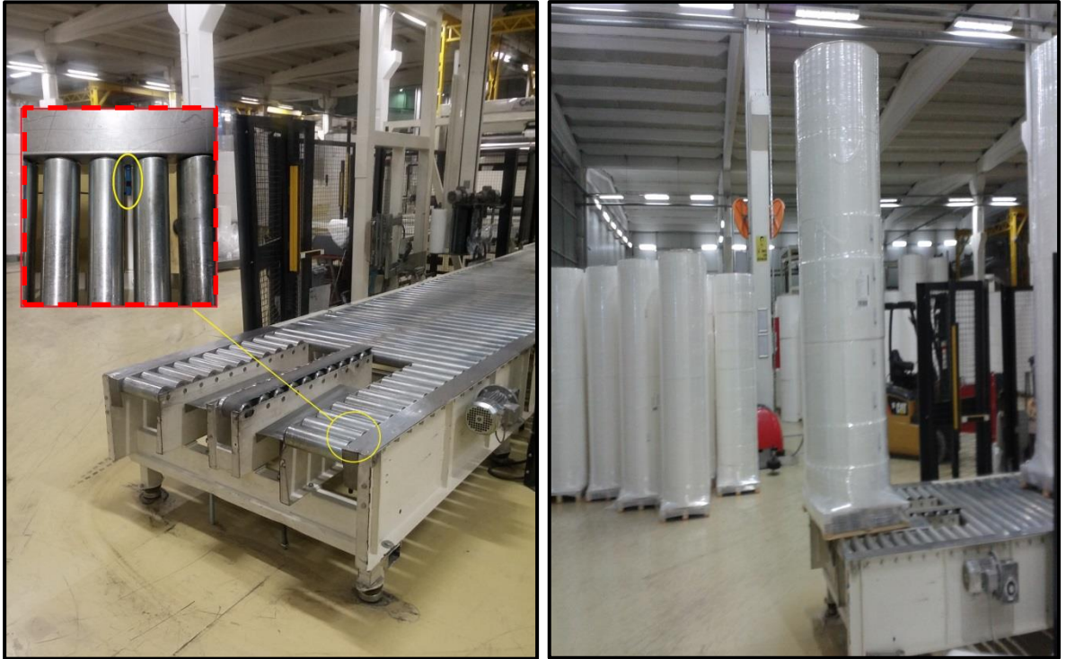
Resim 4.28. Paketlenmiş kumaş rulosu konveyör sonuna geldiğinde konveyörü durduran sensörlü sistemler
