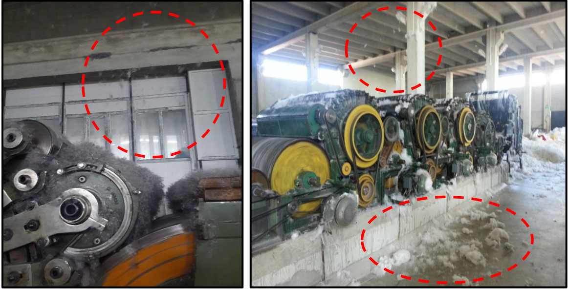
Resim 4.41. Silindir ve dişli sistemlerinin üzerinde muhafaza bulunmayan tarak makineleri ve üretimde ortaya çıkan toz ve uçuntular
