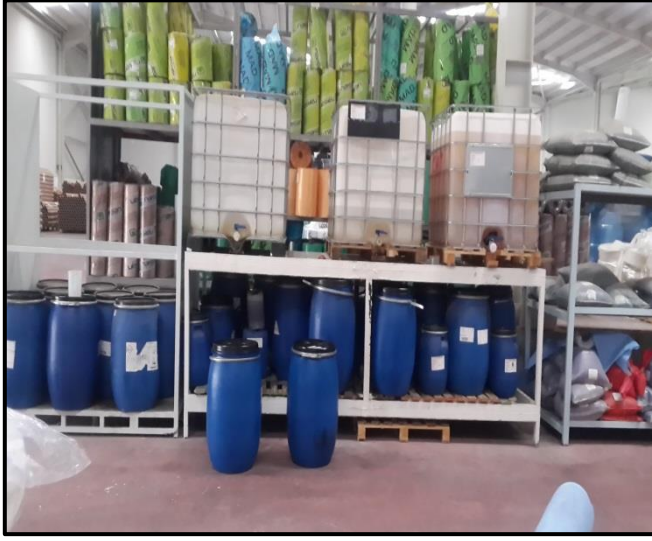
Resim 4.32. Kimyasalların diğer malzeme/ekipmanlarla birlikte depolanması, güvenlik bilgi formlarının bulunmaması ve kimyasalların depolanması için uygun alanlar oluşturulmaması
