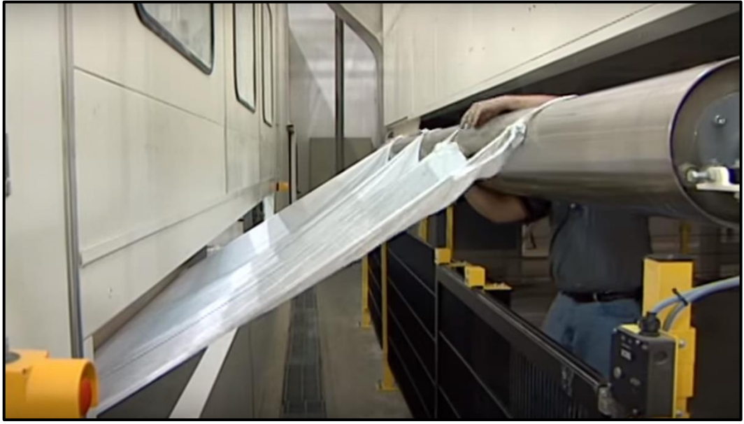
Resim 4.5. Kılavuz kumaş besleme (kumaşa yol verme) işlemi
