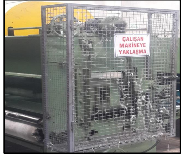
Resim 4.44. İğneleme işleminde iğneli plaka çalışma bölgesine uzuv kaptırma riskini önlemeye yönelik muhafaza uygulaması
