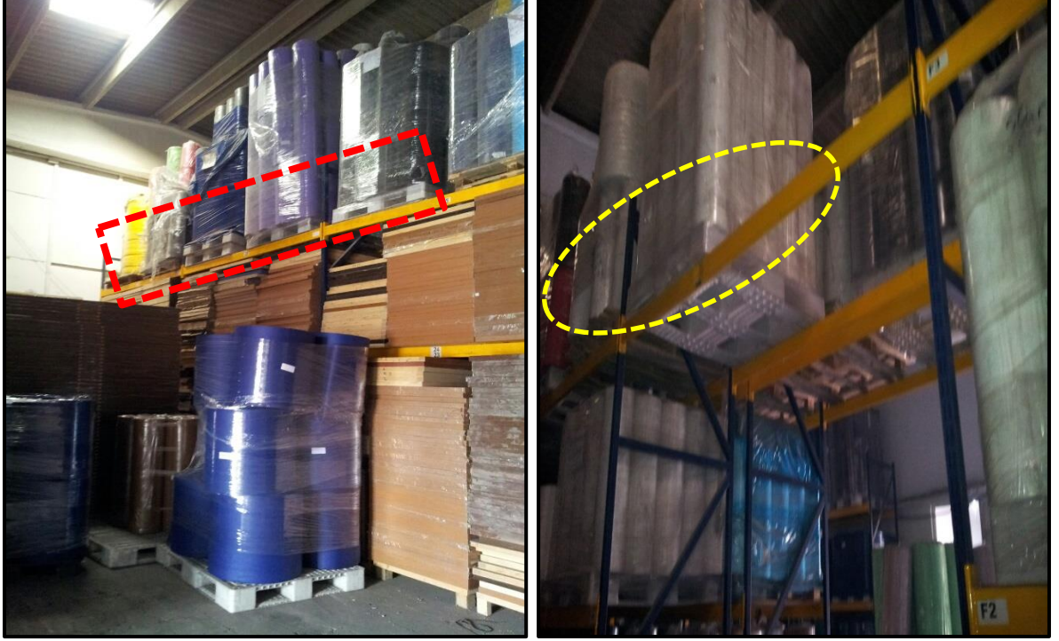
Resim 4.34. Raf sistemlerinde istiflemelerde raflarda raylı sistemli korkuluk bulunmaması
