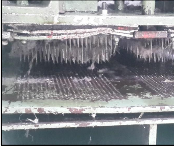
Resim 4.44. İğneleme işleminde iğneli plaka çalışma bölgesine uzuv kaptırma riskini önlemeye yönelik muhafaza uygulaması
