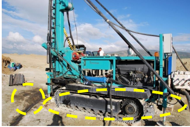
Resim 4.10. Sızıntıya karşı önlem alınmayan sondaj makinesi
