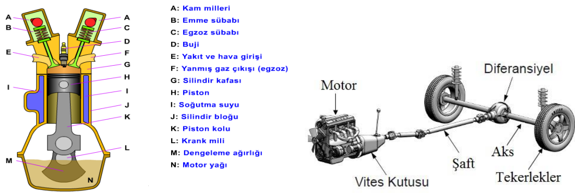
Şekil 2.2. Motor ve iletim sistemleri ile hareket iletim sistemleri [13]
