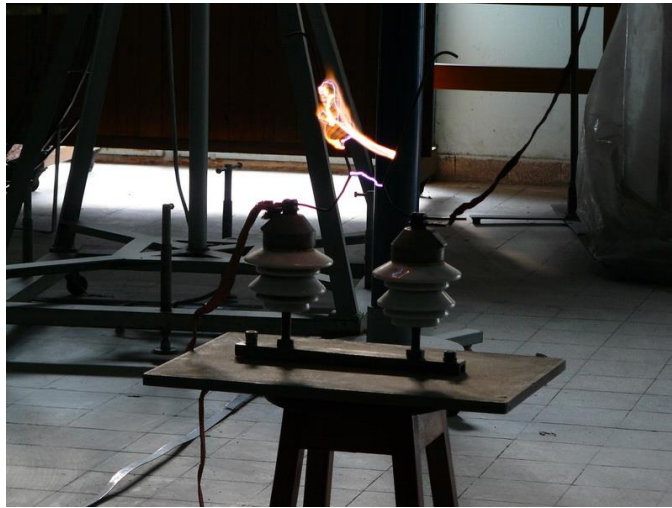
Şekil 18: Yüksek Gerilim Ark Boynuzu Deneyi (15)
