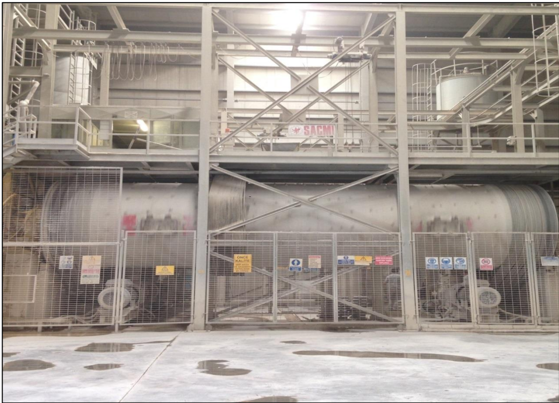
Şekil 2.4. Sürekli çalışan öğütme değirmeni
