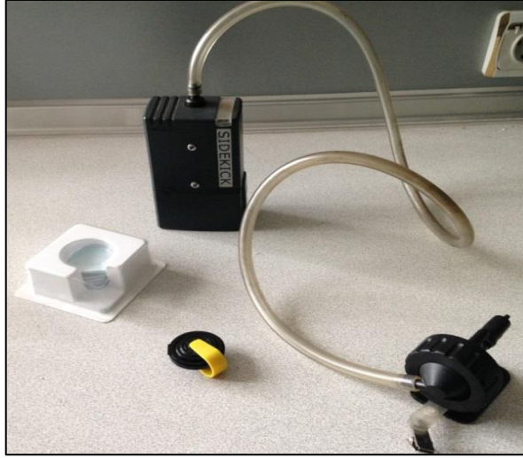
Şekil 3.2. Kişisel hava örnekleme pompası, siklon başlık, PVC filtre ve filtre kaseti
