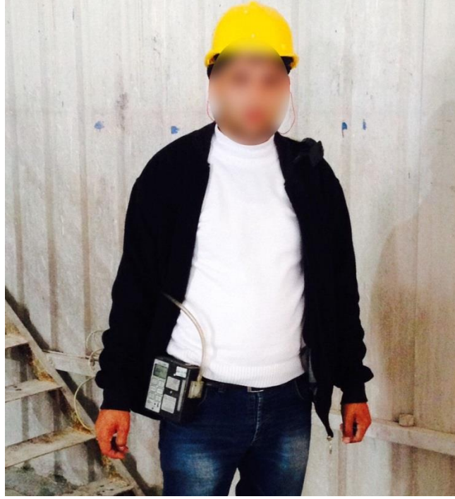
Şekil 3.5. SKC toz pompası ve siklon başlık konumu
