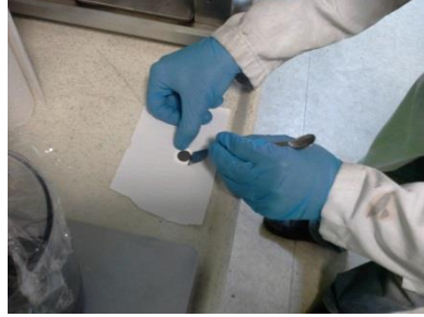
Resim 3.12. Elde Edilen Garfenin Süzgeç Kâğıdından Ayrılması
