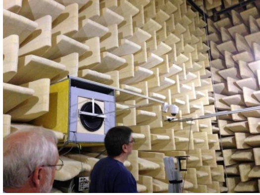
Resim 6. Sessiz oda ve kalibrasyon düzeneği örneği
