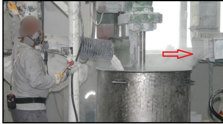
Resim 4.3. Kazana kalsit dökülmesi sırasında oluşan tozun kaynağında emilişi
