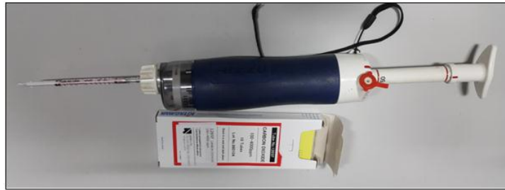
Resim 3.5. Anlık gaz ölçümünde kullanılan dedektör tüp pompası ve dedektör tüpü
