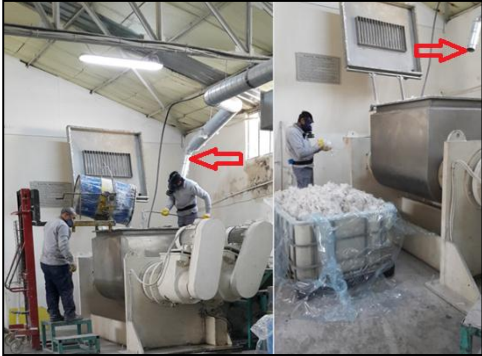
Resim 4.9. Yetersiz lokal havalandırmayla çalışılan BMC makinesine hamur boşaltımı ve kırık elyaf yüklenmesi
