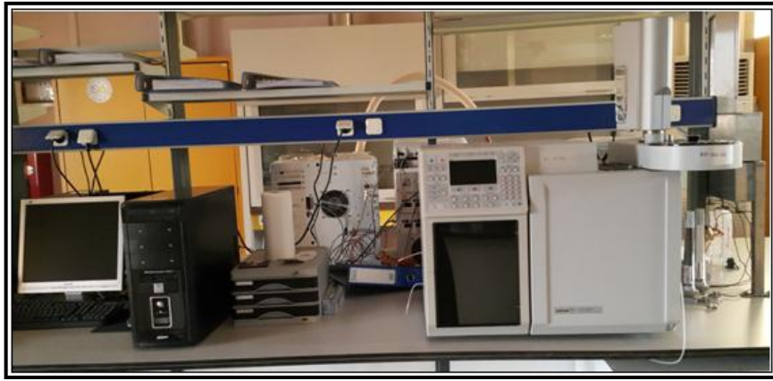
Resim 3.8. Stiren analizinde kullanılan gaz kromatografi cihazı
