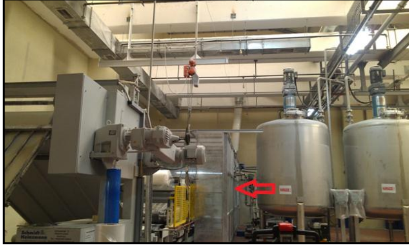
Resim 4.7. Etrafı kapatılmış ve otomasyonla beslenen SMC makinesi
