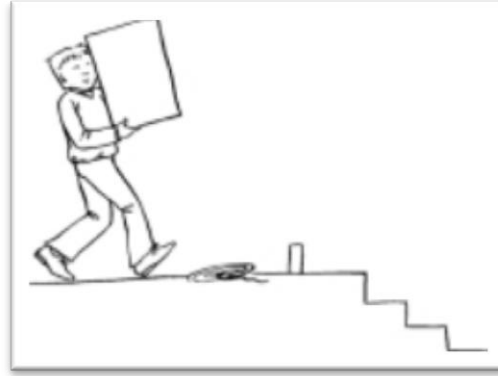
Şekil 6.10. Elle taşıma işleri açısından uygun olmayan çalışma alanı zemini [12]
