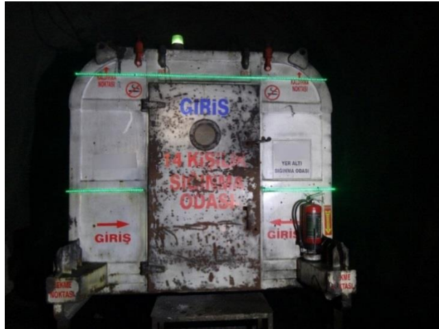
Şekil 4.16. İşletmede bulunan taşınabilir sığınma odasının dışarıdan görünüşü
