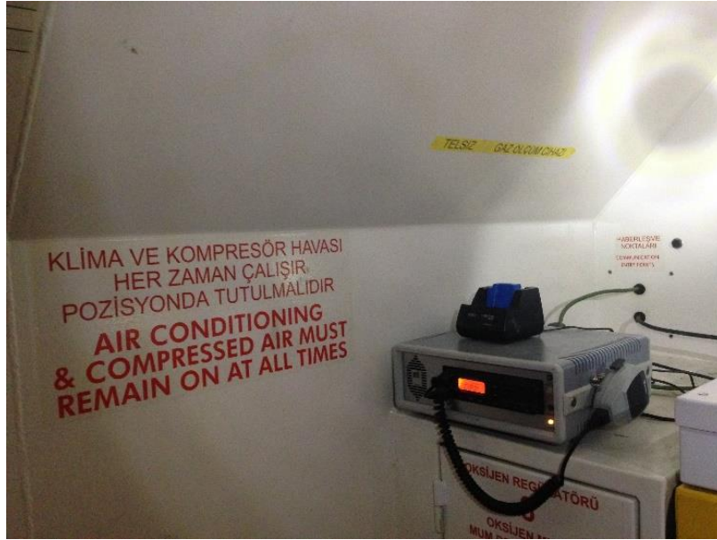
Şekil 4.13. Taşınabilir sığınma odasında bulunan iletişim aracı
