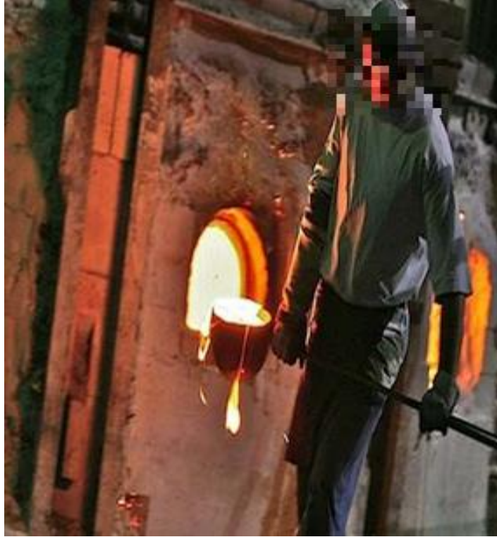
Resim 2.7 El ile Cam İmalatı – Potadan Maden Taşıma
