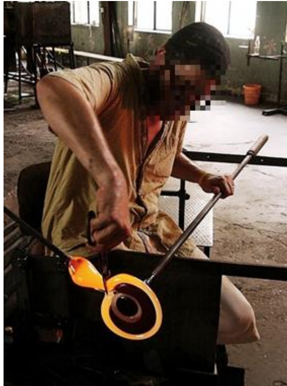
Resim 2.2 Çekme Yöntemiyle Şekillendirilmiş Cam Malzeme
