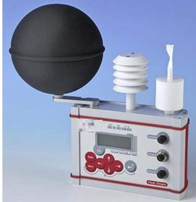
Şekil 3.7 Termal Konfor Ölçüm Cihazı
