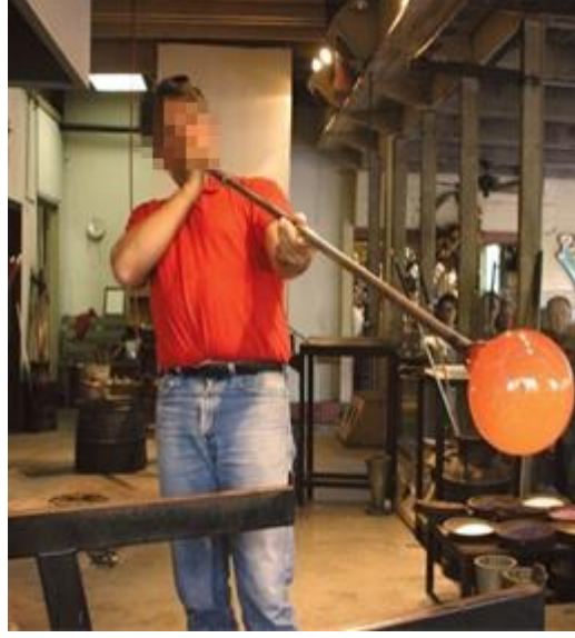
Resim 2.1 Üfleme Yöntemiyle Cam Şekillendirme
