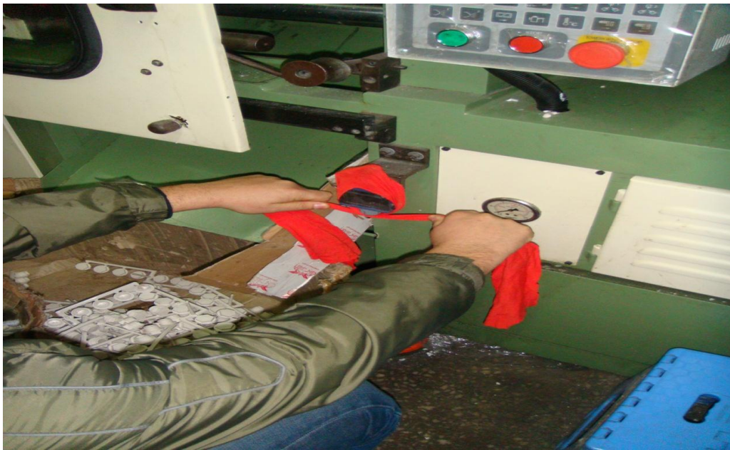
Resim 15. Plastik Enjeksiyon Kalıp Makinesinde Güvenlik Sensörünün Kapatılması
