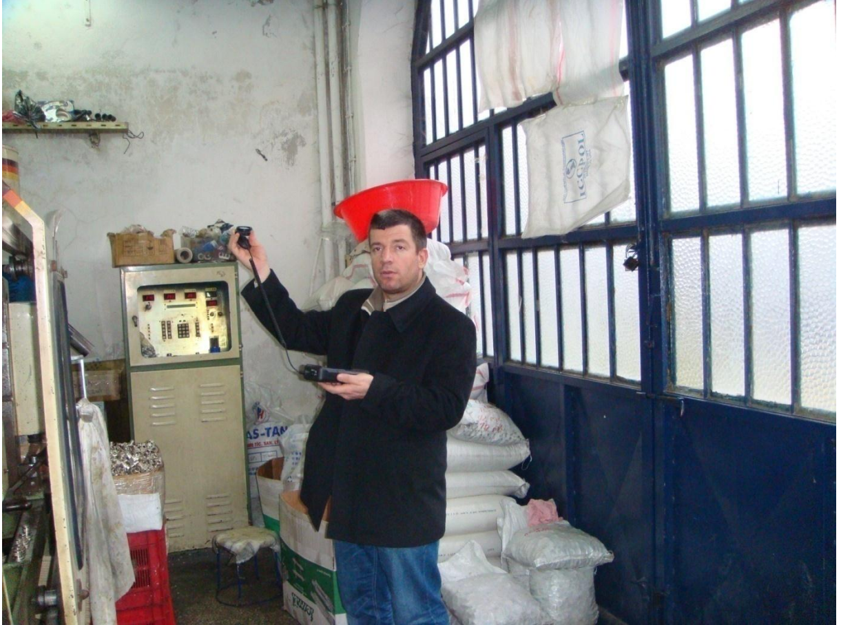
Resim 14.İnceleme Yapılan İşletmenin İmalat Bölümündeki Makine Parkuru Balı Tarafında Yapılan Aydınlatma Ölçümü
