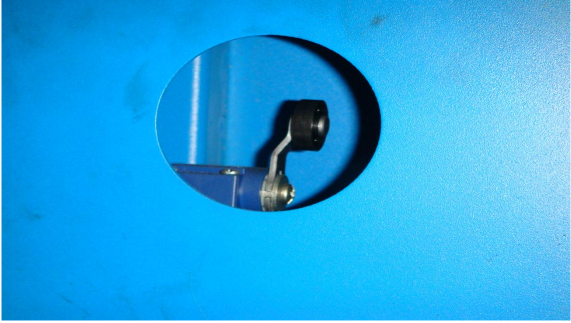
Resim 16. Plastik Enjeksiyon Kalép Makinesinde Gizli Güvenlik Sensörü
