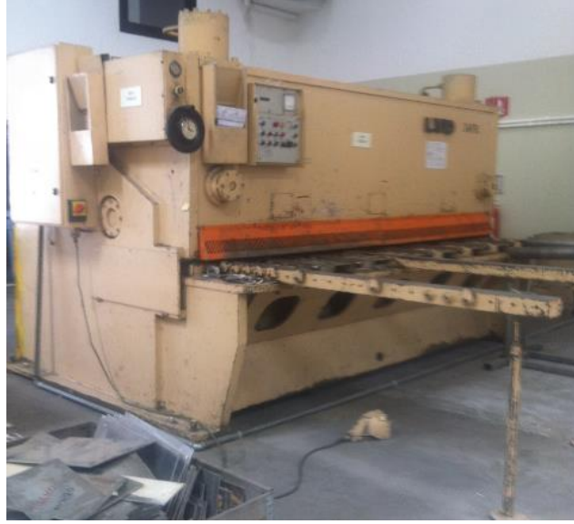
Resim 3.8. Giyotin makas ile kesim işlemi
