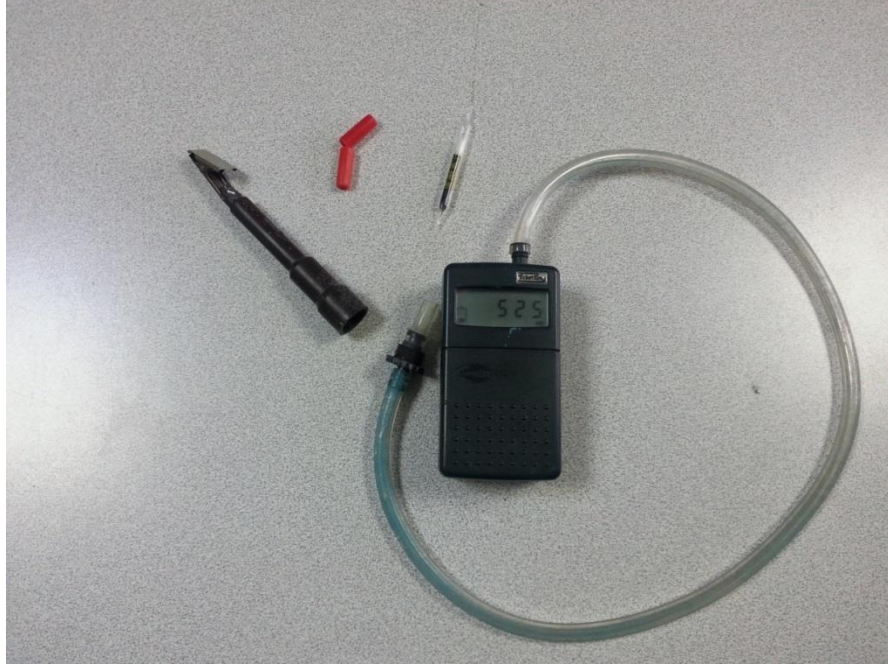
Resim 3.4. Kişisel örnekleme pompası, başlık ve örnekleyici tüp
