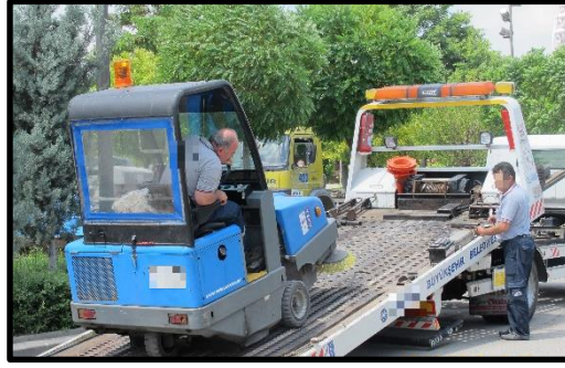
Resim 4.36. Süpürme makinesinin araca yüklenmesi
