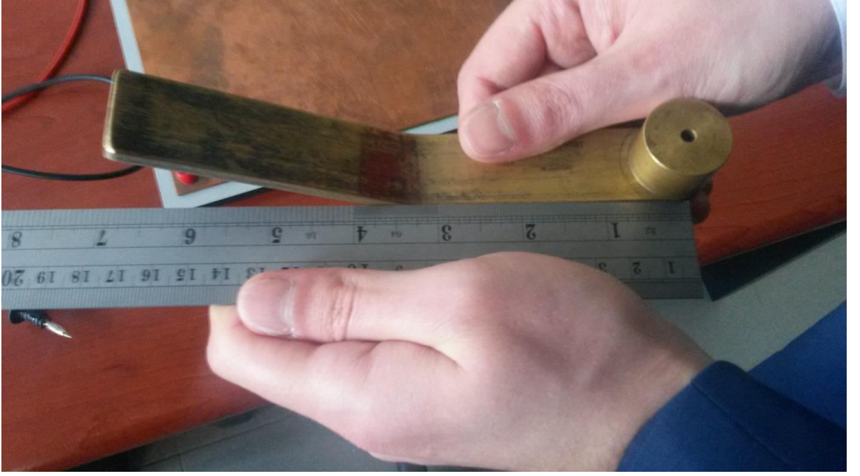
Resim 3.5.İç elektrotun kalite kontrol ölçümü
