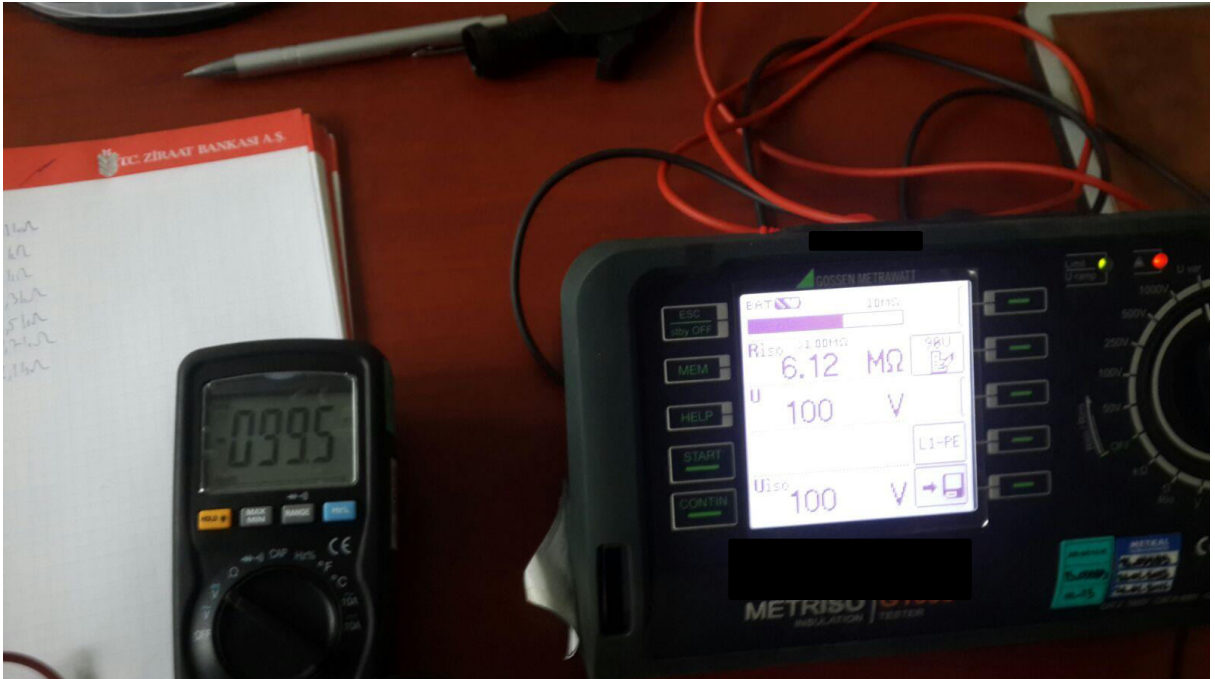
Resim 3.2. Cihazın ve multimetrenin gerilim göstergelerinin karşılaştırılması
