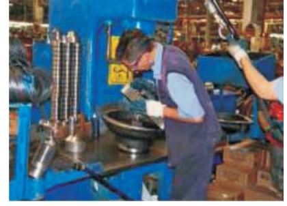
Şekil 7. Kapağın aks üzerine montaj işlemi
