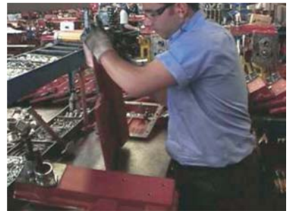
Şekil 12. Vites kapağının masa üzerinde ters yüz edilmesi
