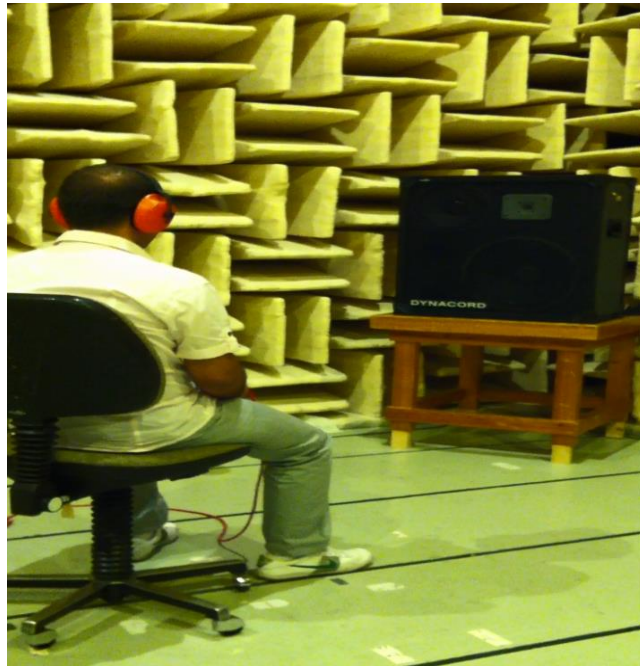
Şekil 35. Yarı yankılı odada kulak koruyucu testi
