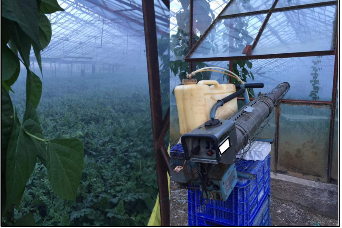
Resim 4.3. ULV makinesi ile pestisit uygulaması
