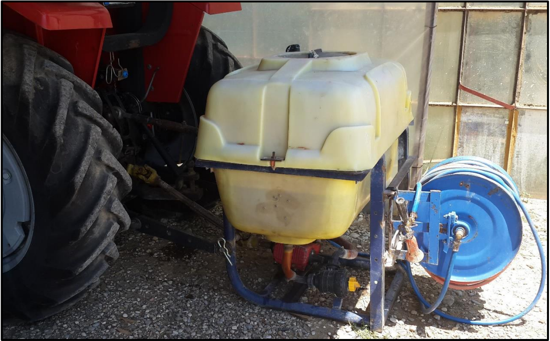
Resim 4.13. Kuyruk mili muhafazası sökülmüş pülverizatör
