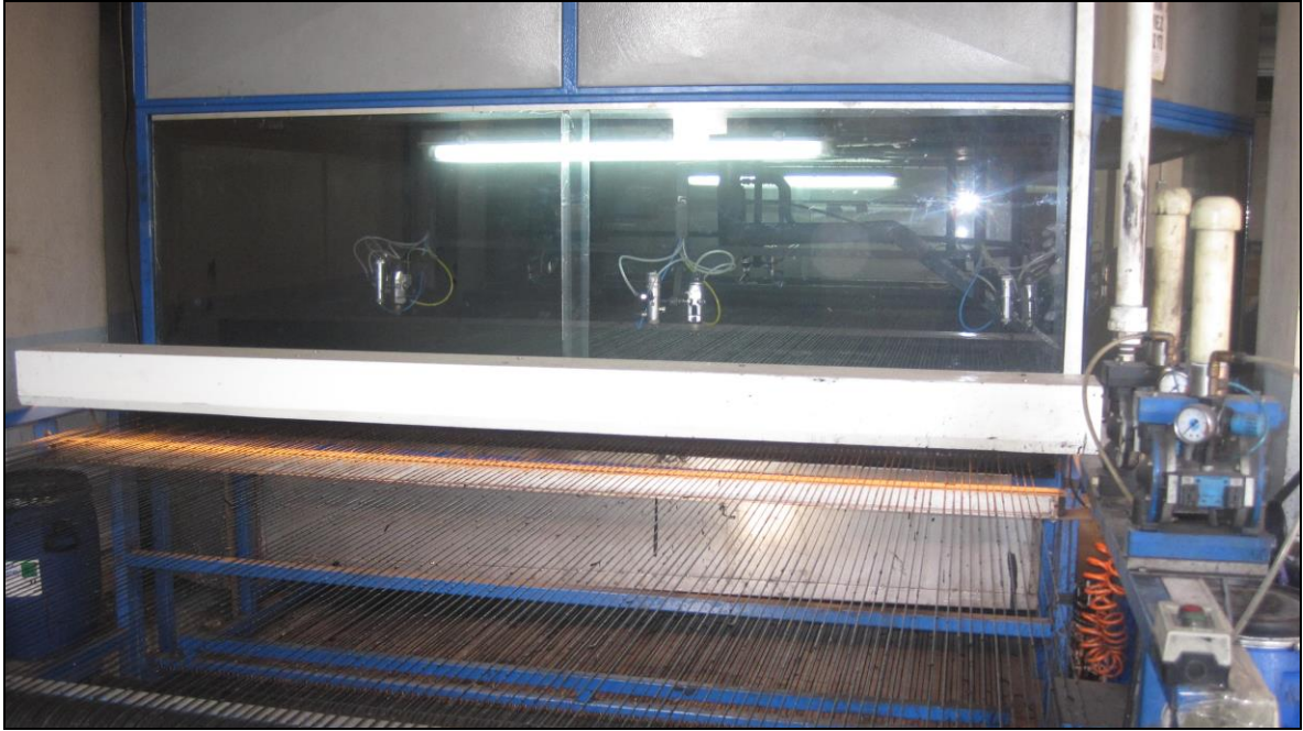
Şekil 5. Deri imalatı sürecinde son işlemlerden renk verme işlemi
