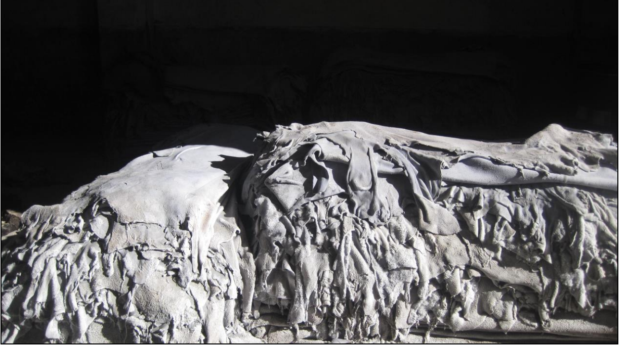
Şekil 4. Sepileme işlemi sonrası derinin aldığı wet blue hali
