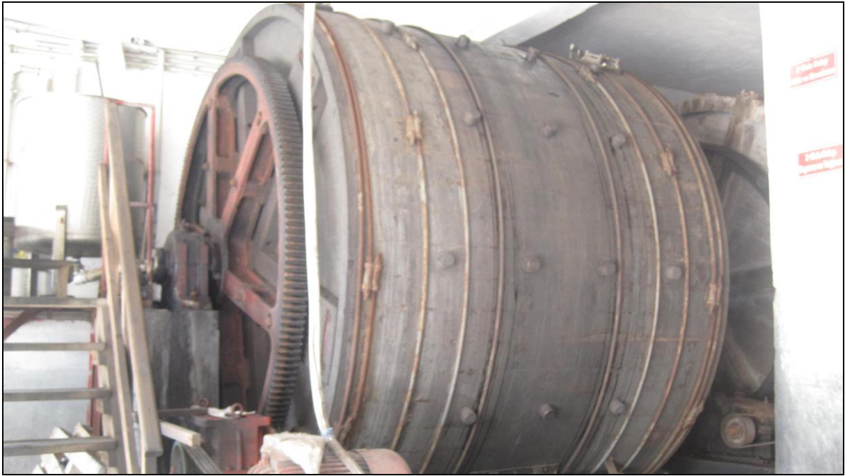
Şekil 3. Deri imalatı işlerinde kireçleme süreci
