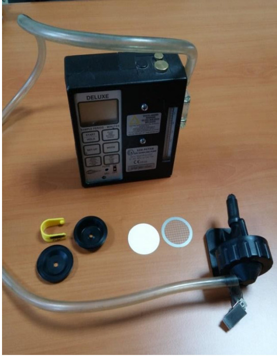
Resim 3.1. Toz ve Silis Örneklemesinde Kullanılan Toz Pompası ve Tartı Aleti
