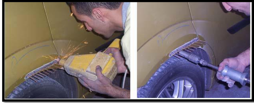
Resim 2.5. Perçin kaynatarak düzeltme [11]
