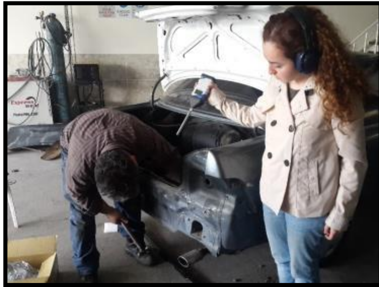
Resim 3.3. Görev tabanlı gürültü ölçümü
