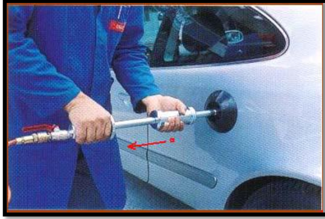
Resim 2.3. Vakumlu pnömatik çekirme cihazı ile parça onarımı [11]
