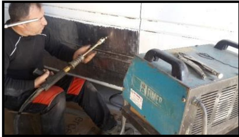
Resim 2.4. Spot hızlı çekirme cihazı ile kaporta düzeltme
