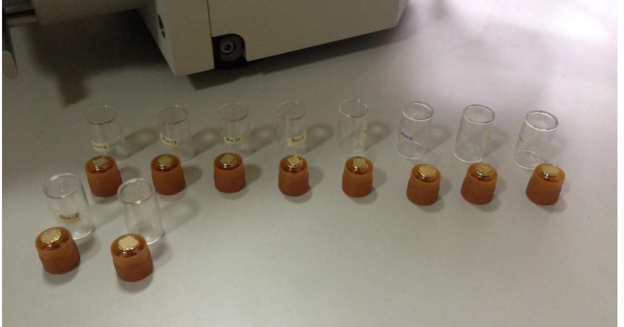
Şekil 23. Yüzey altın kaplanmış PAN numuneleri
