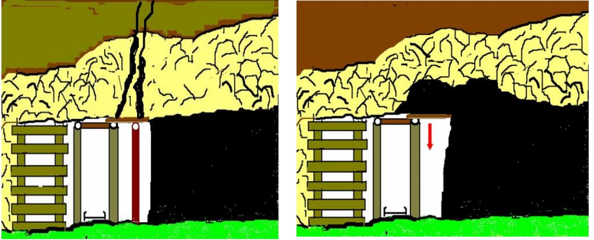
Şekil 2.7.a. Tavan Çatlağı Olması Durumu Örneği (solda) b. Tavanda Kömür Yükselmesi Örneği (sağda) [22]
