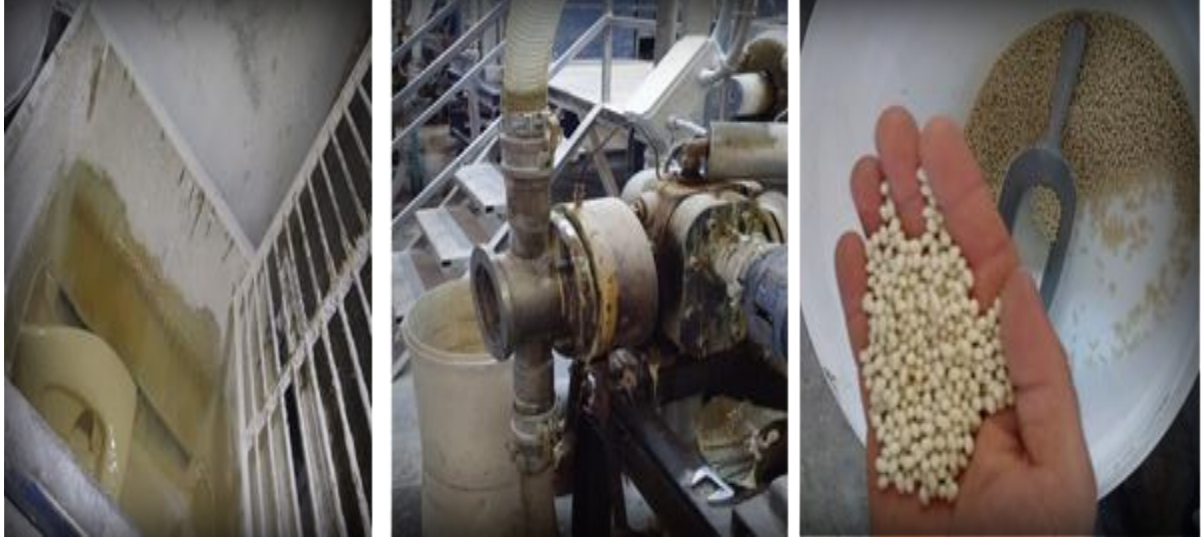
Resim 2.4. Kazanda karıştırılan sıcak eriyik tutkal hamuru (solda), taneleyici (ortada)
