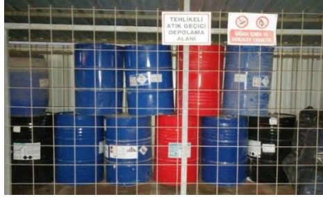
Resim 4.8. Patlama oluşturacak şekilde depolanan malzemeler
