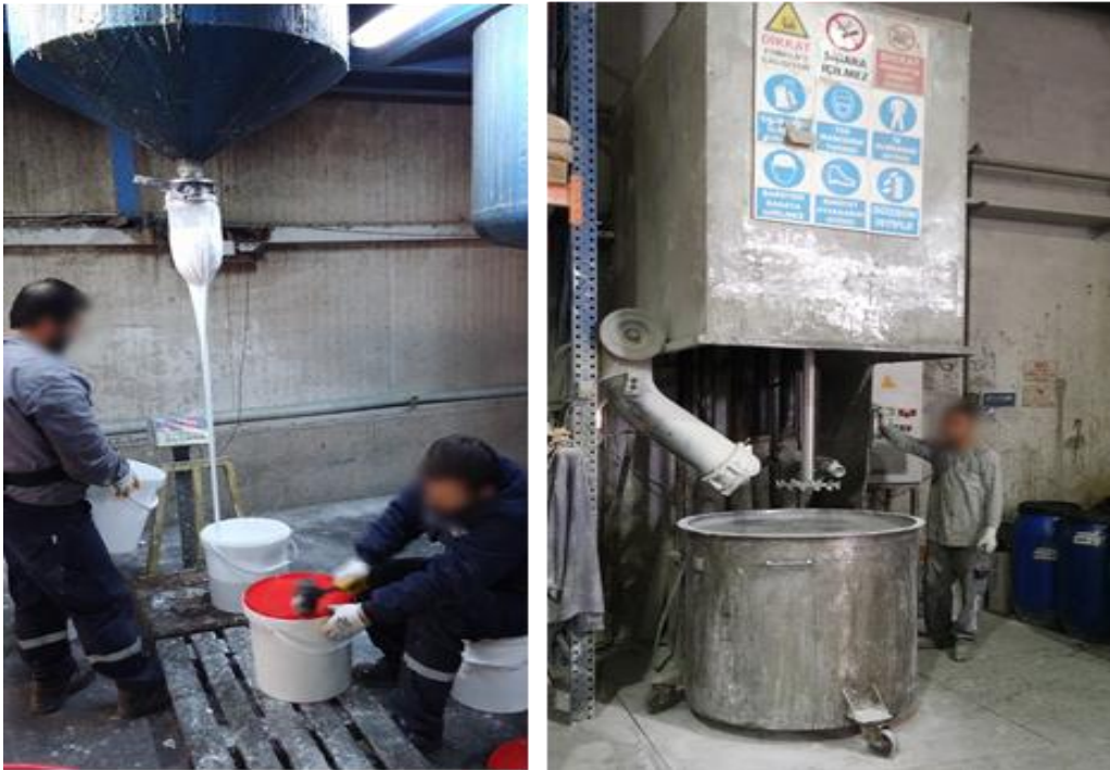
Resim 2.3. Kapalı (solda) ve açık (sağda) sistemle üretilen su bazlı tutkal
