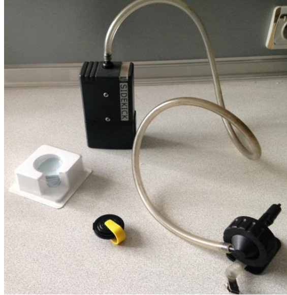
Resim 4.24. Kişisel hava örnekleme pompası, siklon başlık, PVC filtre [25]
