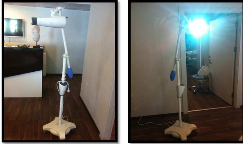
Resim 4.17. Diş beyazlatma işleminde kullanılan optik radyasyon kaynağı cihaz
