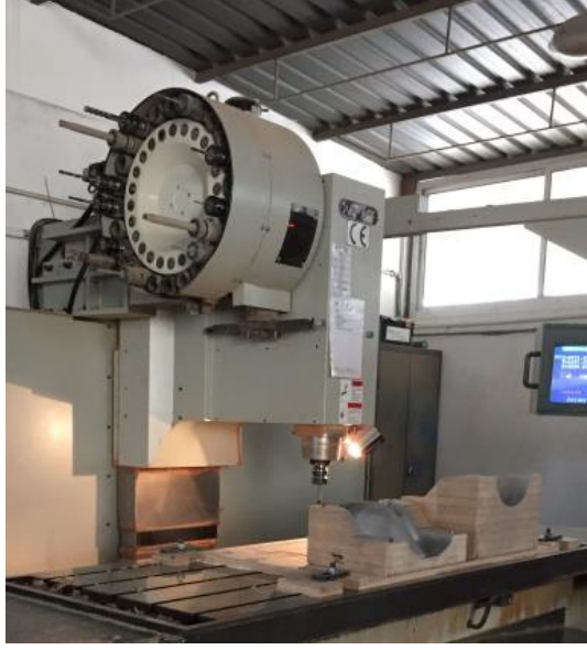
Resim 2.1. Modelhanede model yapımı
