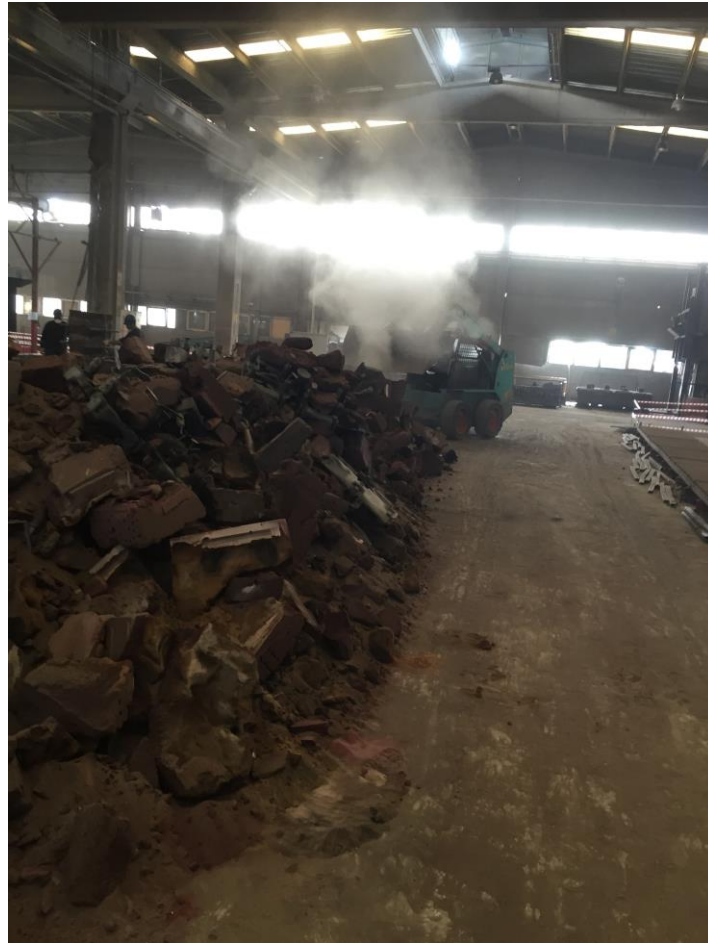
Resim 2.10. Kalıp bozma işlemi
