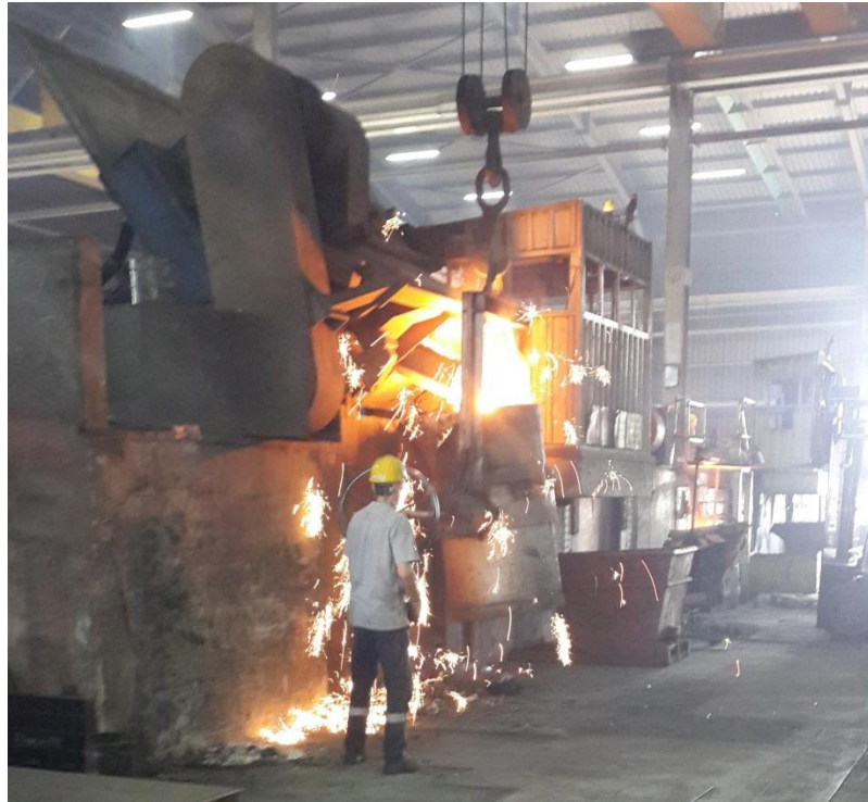
Resim 4.1. Ocaktan potaya malzeme alımı
