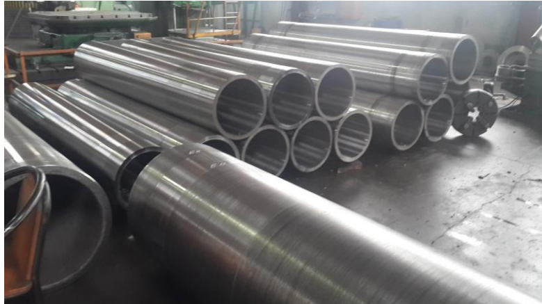
Resim 2.7. Santrifüj döküm ile elde edilen parçalar
